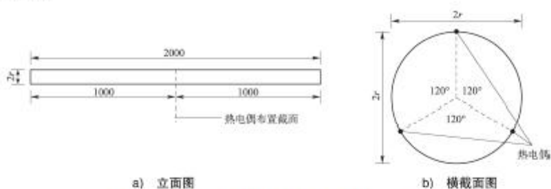
图 A.3.2 钢索/钢棒型试件测点布置图(尺寸单位:mm)
