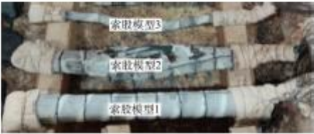
图 B.5.3-1 不同直径试件抗火带防护效果对比试验
