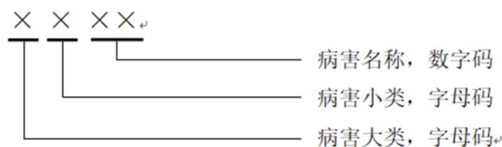
图A.1 路面及其设施识别病害编码结构
