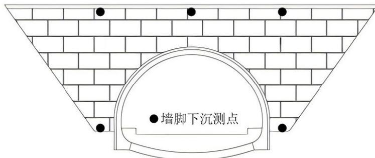
图 A.3 端墙式洞门位移监测点布置示意图
