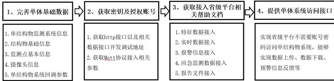
图 C.1 单结构物监测系统与省级平台对接流程示意图
