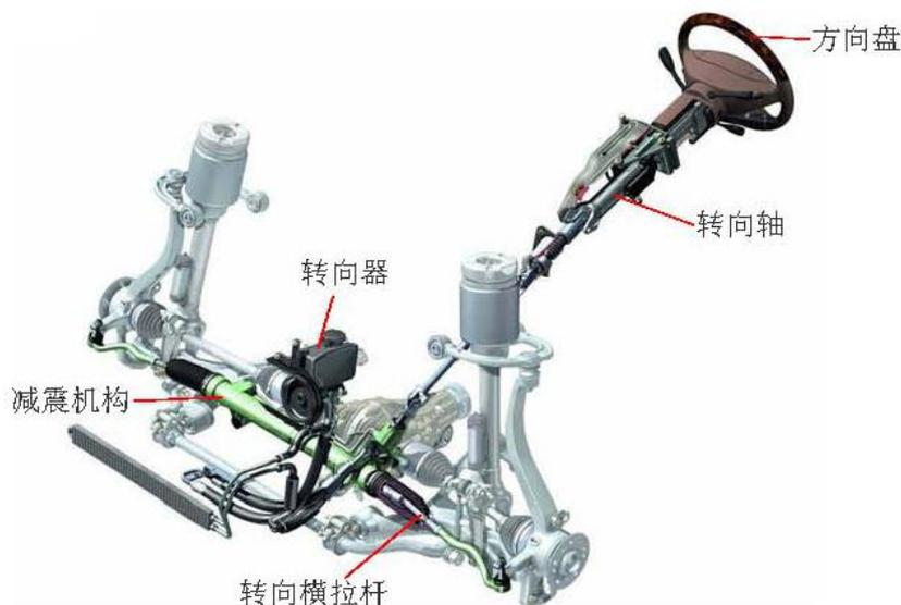
图 B.1 转向系统示例
